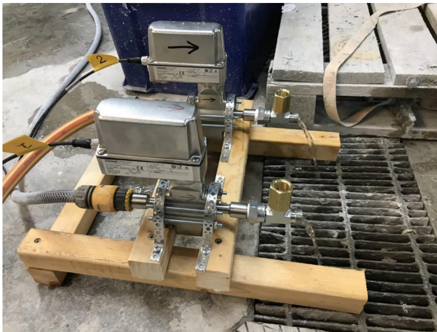
Figur 17. Kranvatten användes för att testa om signalomvandlingsmaskinen gav korrekta avläsningar till DAQ-systemet.
